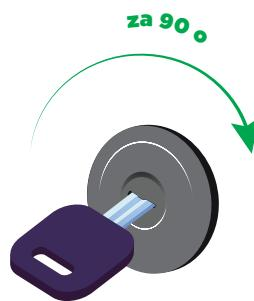
2. OKRENUTI KLJUČ U SMJERU KAZALJKE NA SATU ZA 90° I PRIČEKATI ZVUČNI SIGNAL (KLIK).
