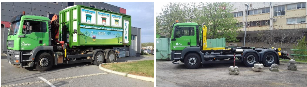
Komunalno vozilo navlakač kontejnera za potrebe prijevoza MRD i rolo kontejnera kapaciteta 16-30m 3
